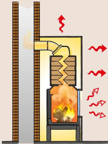
Der Grundofen gibt langsam und wohldosiert Wärme an den Aufstellraum ab – so wird ein Überhitzen des Raumes verhindert. Ideal für Neubauten und Räume mit geringem Wärmebedarf und überall dort, wo langanhaltende Strahlungsleistung gewünscht wird.
