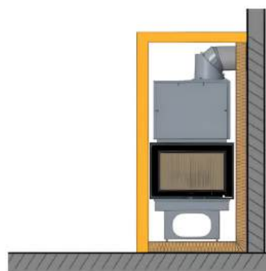
FINA s horným výmenníkom ako akumulčný krb
